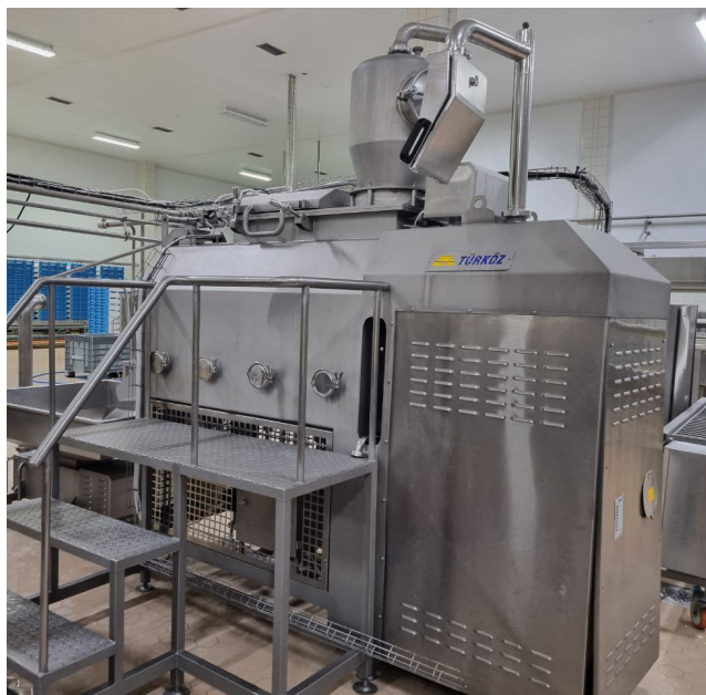
Рисунок 6. Котел для производства мягкой группы сыров (пицца-чиз, моцарелла) на 300 кг/партия
