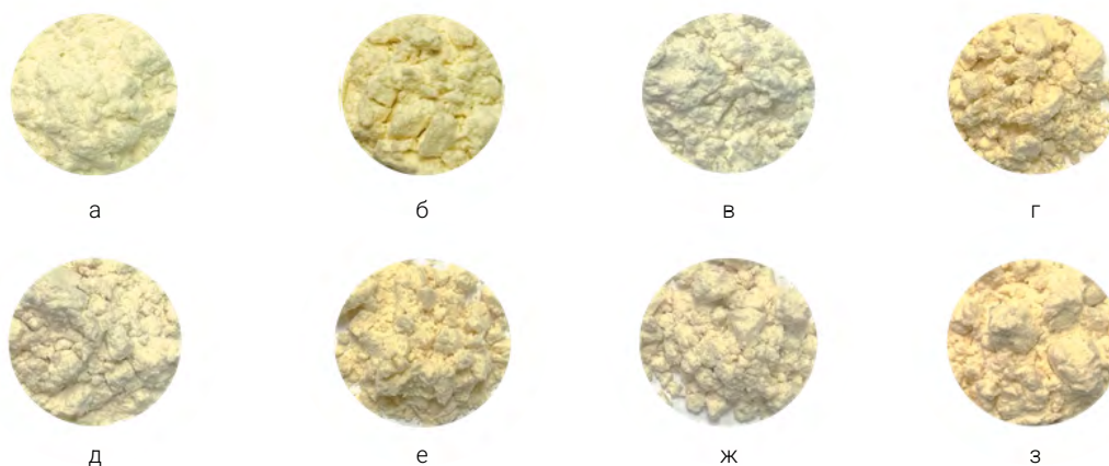
Рисунок 1. Визуальная оценка слеживаемости образцов высокобелковых молочных компонентов после хранения при заданных условиях в течение 2 мес.: а) КМБ 6 °С; б) КМБ 45 °С; в) КМК 6 °С; г) КМК 45 °С; д) КСБ 6 °С; е) КСБ 45 °С; ж) ЛКСБ 6 °С; з) ЛКСБ 45 °С
